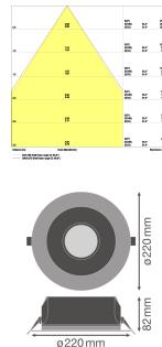
Technische Daten Ledvance LED Downlight Performance DN195 21W 2520lm 65D - 840 Kaltweiß | 220mm - IP54
