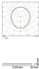
Technische Daten Ledvance LED Feuchtraumleuchte Feuchtigkeitsdicht 46W 6400lm - 840 Kaltweiß | 150cm - Bewegungs- Und Lichtsensor
