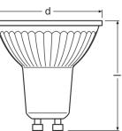
Technische Daten Osram Parathom LED-Spot GU10 PAR16 6.9W 575lm 36D - 830 Warmweiß | Ersatz für 80W
