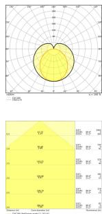
**Technische Daten Ledvance LED Röhre T8 Performance (EM/Mains) Ultra Output 24W 3600lm - 865 Tageslichtweiß | 150cm - Ersatz für 58W**
