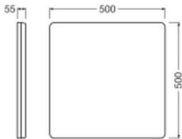
**Technische Daten Ledvance Led-Wand- Und Deckenleuchte Surface Eben Lichtquellen Quadrat Weiß 23W 3780lm - 830-840 CCT | 500mm - IP20**
