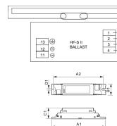
Technische Daten Philips HF-S 154 TL5 II 220-240V 50/60Hz
