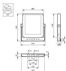
**Technische Daten Philips Led-Scheinwerfer Coreline BVP140 Aluminium 225W 31500lm 73x26D - 740 Kaltweiß | IP66 - Dali Dimmbar - Symmetrisch**
