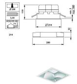
Technische Daten Philips LED Downlight LuxSpace Quadrat DN572B VLC-E 10.3W 1350lm 80D - 830 Warmweiß | 214mm - Dimmbar - Aluminium Reflektor - Dali Dimmbar
